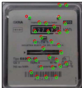
Fig. 4. Resultado del cálculo del vector de flujo óptico (Algoritmo Lucas Kanade) en carátula de un medidor.
