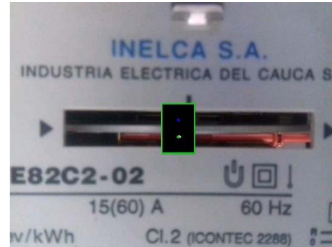
Fig. 8. Sustracción de fondo aplicada a la región de interés.
