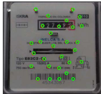
Fig. 2. Resultados de aplicar el detector de esquinas (algoritmo Shi-Tomasi) en carátula de un medidor.
