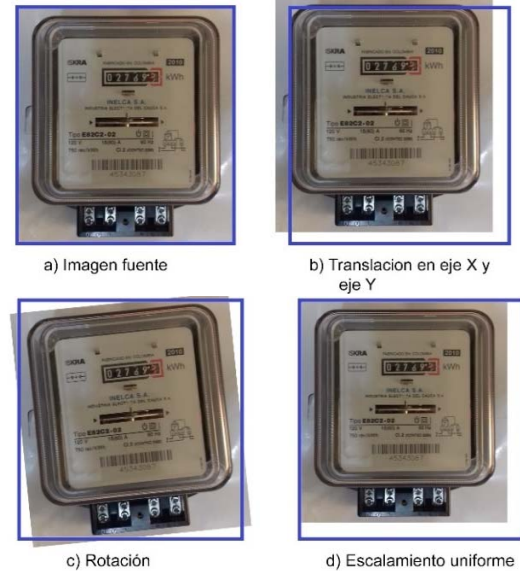
Fig. 5. Movimientos considerados para el proyecto en la carreta de un medidor (a. Imagen original, b. Traslación en ejes (x,y), c. Rotación y d. Escalamiento uniforme).
