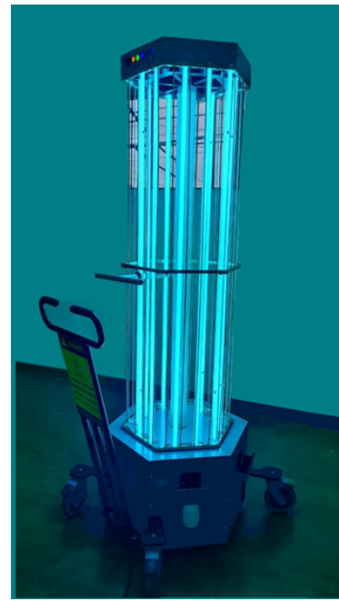
Fig. 1. SIDUV-C: Robô UV-C não autônomo de 3900 W utilizado para desinfecção de ambientes hospitalares e ambulatoriais.
