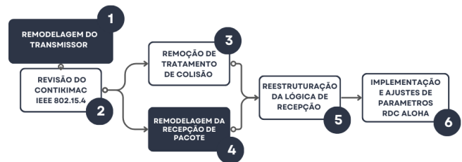
Fig. 2. As fases de operação da implementação do Aloha para o Contiki-OS são: 1) Remodelagem do Transmissor; 2) Análise e revisão do código-fonte original do ContikiMAC; 3) Remoção dos mecanismos de tratamento de colisão do CSMA/CA, conforme a especificação IEEE 802.15.4; 4) Remodelagem da recepção de pacotes; 5) Reestruturação da lógica de recepção para adequar-se ao funcionamento do Aloha com RDC; e 6) Implementação do mecanismo de RDC compatível com Aloha, com testes e ajustes nos parâmetros de backoff para otimização do desempenho do Aloha com RDC.
