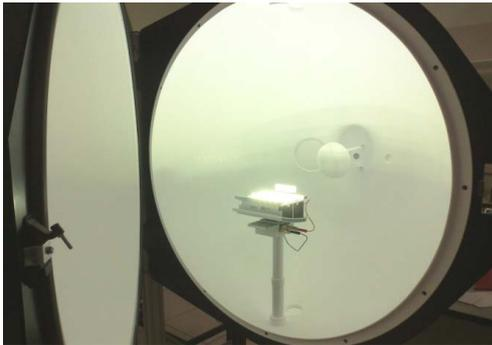
Fig. 2. A esfera integradora empregada nas medições relatadas neste artigo (um módulo de LEDs de alta potência está emitindo luz no interior da esfera).
