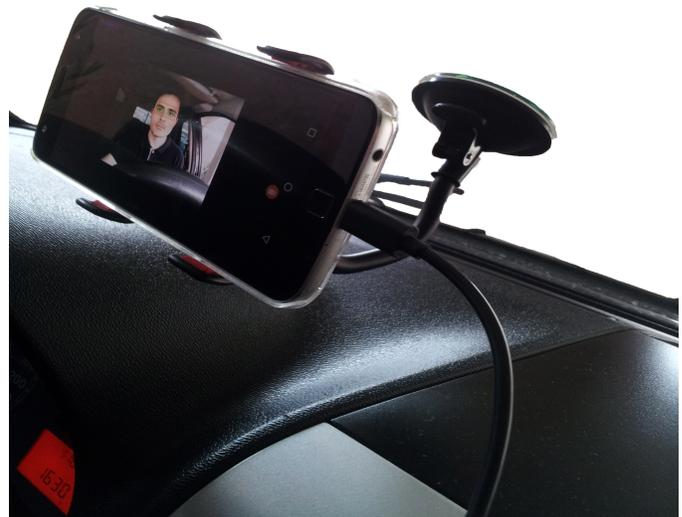
Fig. 7. Estrutura do sistema de monitoramento da sonolência do condutor. O smartphone é fixado com a parte frontal virada para o motorista por meio de um suporte preso ao para brisa.
