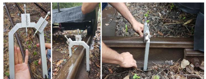
Fig. 15. Gabarito manual usado no experimento em campo.
