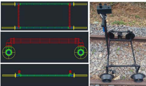
Fig. 4. Projeto e montagem do trolley .
