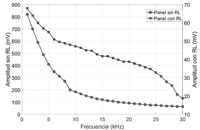
Fig. 7. Respuesta en frecuencia del receptor VLC. La parte derecha del eje y, representa la amplitud considerando resistencia de carga en el panel solar. Mientras que la otra parte del eje y, representa la amplitud del sistema sin considerar resistencia de carga.
