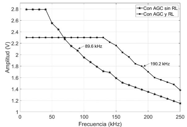
Fig. 8. Respuesta en frecuencia del sistema VLC con AGC
