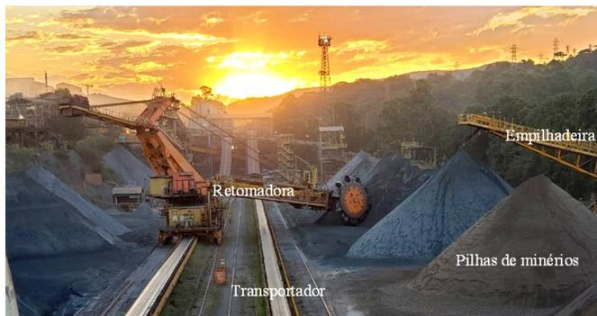
Fig. 1. Processo de retomagem de minério de ferro.
