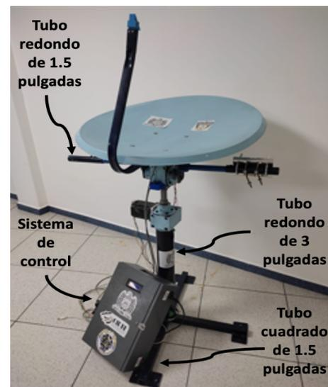
Fig. 9. Sistema Mecánico con seguimiento satelital.
