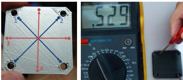
Fig. 5. Puntos de medida de un cortocircuito (izquierda). Medida de resistencia eléctrica en baja frecuencia de un cortocircuito (derecha).
