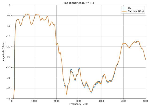
Fig. 14. Comparación de las firmas espectrales, en naranja, la obtenida al procesar el SpuR, a partir de la señal recibida de la etiqueta Nº 4 y en azul, la firma almacenada en la base de datos.
