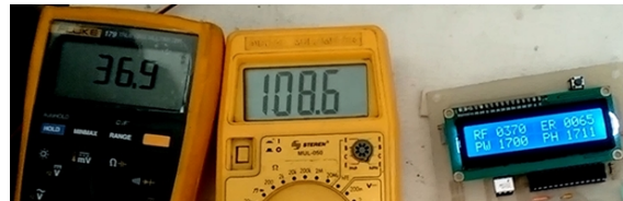
Fig. 21. Display: RF (Temperatura del agua deseada), PW (Potencia de calefacción requerida), ER (Desviación de temperatura) y PH (Potencia de calefacción consumida).
