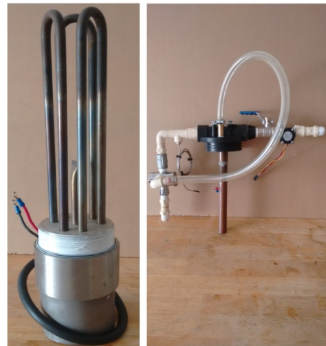
Fig. 14. Elementos calefactores y conexiones hidráulicas.
