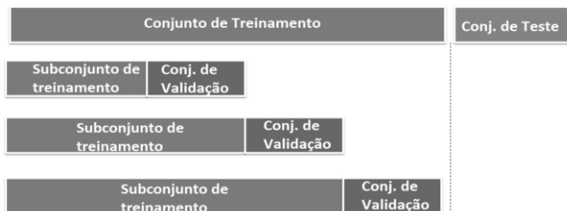
Fig. 3. Método de validação cruzada com janela incremental - Increasing Window Cross Validation
