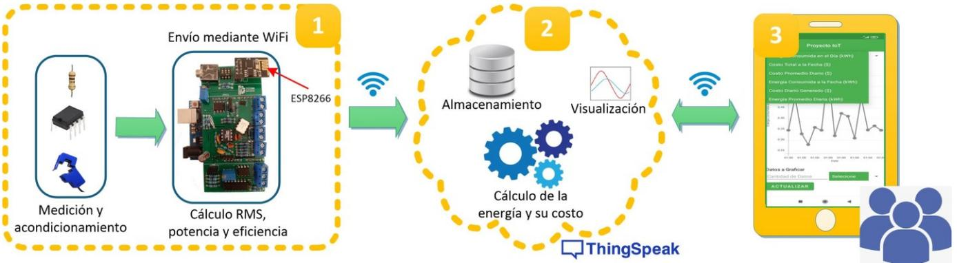
Fig. 1. Sistema de monitoreo del consumo de energía eléctrica mediante IoT.
