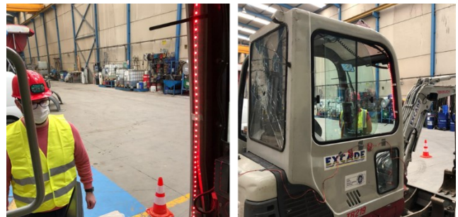
Fig. 5. Utilización del prototipo de ADAS en un contexto real. Detalle de tiras led en rojo por la proximidad de un operario (a) y vista general del vehículo durante las pruebas (b).
