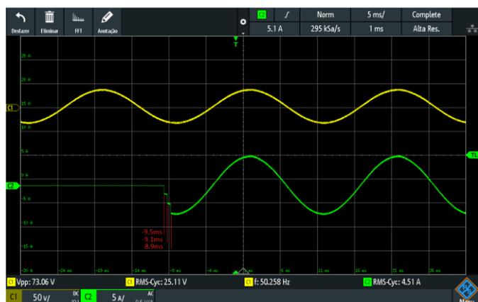
Fig. 11: Forma de ondas da tensão e corrente de saída para um degrau com uma carga resistiva.
