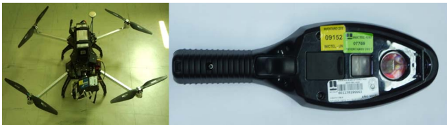
Fig. 1. Fotografía de un UAV cuadrícóptero (izquierda) y un instrumento manual Greenseeker ® (derecha).
