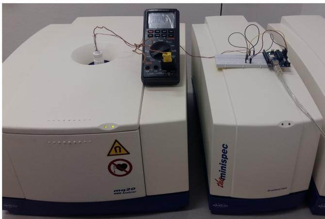
Fig. 6. Foto do espectrômetro Minispec mq20 com sistema manual de calibração de temperatura (multímetro) e protótipo do sistema automatizado utilizando Arduino.
