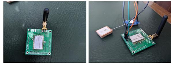
(a) Prototipo del nodo receptor      (b) Prototipo del nodo de rastreo
