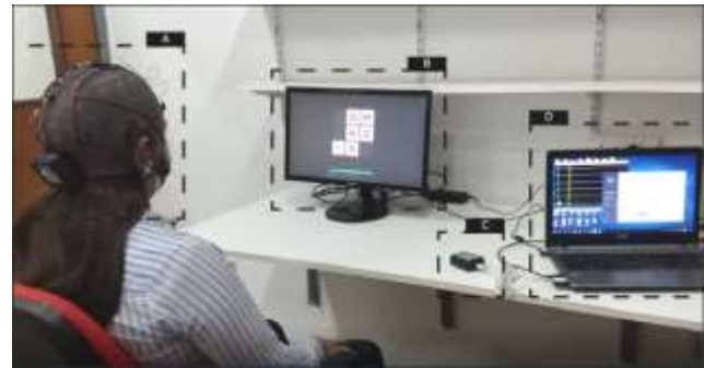
Fig. 5. Fotografía de una de las voluntarias durante la realización de una tarea. (A) Amplificador g.Nautilus Research (B) Monitor con la Interfaz de usuario paciente. (C) estación base g.Nautilus conectada a la computadora portátil vía USB. (D) Computadora portátil con la Interfaz de usuario profesional.
