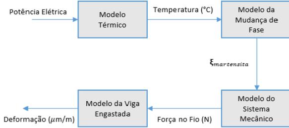
Fig. 6. Diagrama de blocos do modelo de atuador LMF.
