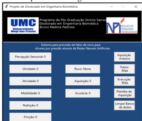
Fig. 7. Tela do software de supervisão com os parâmetros lidos do sensor, a resposta da RNA e os botões de execução.
