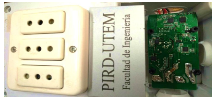
Fig. 2b. Circuito impreso de Smart Socket implementado.
