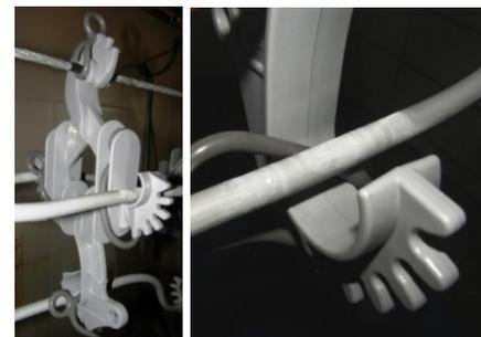
Figura 10. Berço direito do espaçador com pequenas alterações nas interfaces entre o condutor e o espaçador e também internamente ao espaçador: a) E-3, b) E-4.
