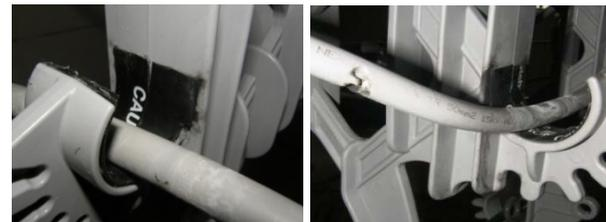
Figura 9. Detalhes do espaçador com erosões e trilhamento no cabo e no espaçador: a) E-1, b) E-2.
