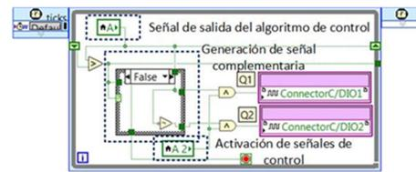
Fig. 10. Esquema de programación del controlador para el rectificador.
