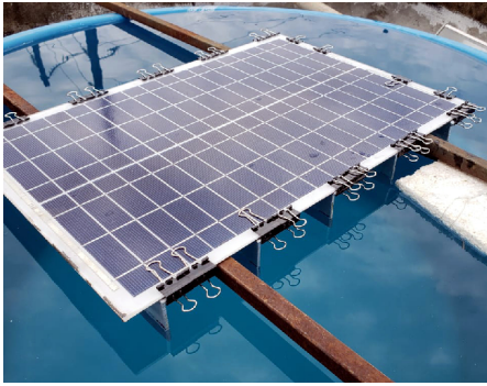
Fig. 4. Módulo FV modelo KS20T de 20 Wp flutuante com pontes de calor apoiado em suporte.
