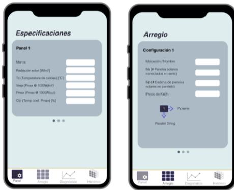
Fig. 11. Pantallas de la App para ingresar los parámetros de los paneles solares y la configuración del arreglo. Fuente: Los autores.
