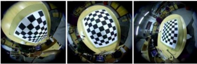
Fig. 3. Imágenes de tres vistas del tablero tomadas con la cámara *fisheye* que fueron utilizadas para la calibración intrínseca de la cámara FE.
