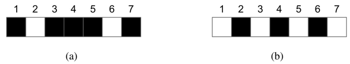
Fig. 7. Exemplo de alternância de cores de uma mesma linha do (a) finder pattern e (b) timing pattern .
