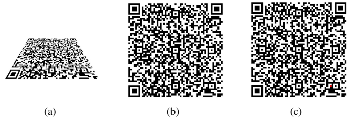
Fig. 9. Exemplo de perspectiva em relação a x , onde (a) QR Code 4 com \theta_x = 55^\circ , (b) imagem resultante e (c) imagem diferença.
