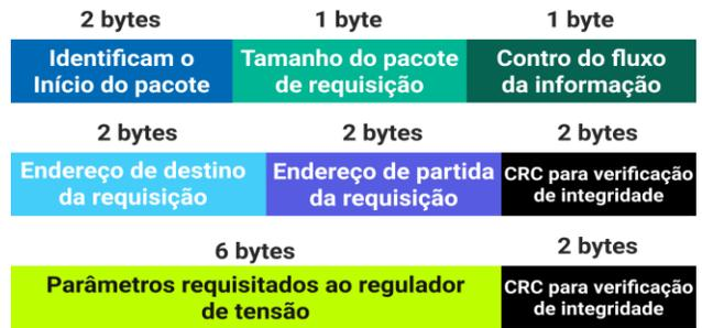
Fig. 2. Estrutura do Pacote de Solicitação de Parâmetros de Controle ao RT
