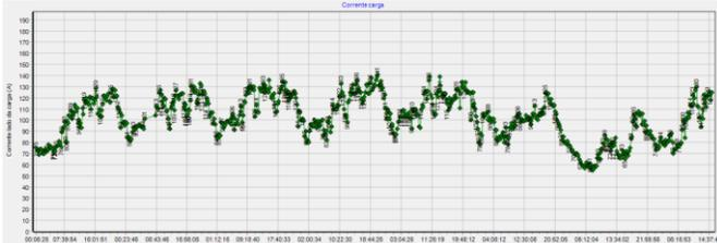
Fig. 10. Demonstrativo de relatório de corrente na carga no período de 7 dias
