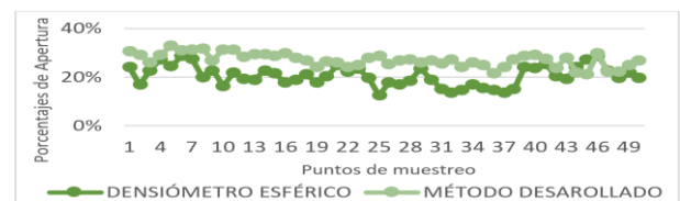
Fig. 10. Comparación de porcentajes de apertura obtenidos en el entorno III en el parque ecológico entre el Densiómetro Esférico y Método Desarrollado.
