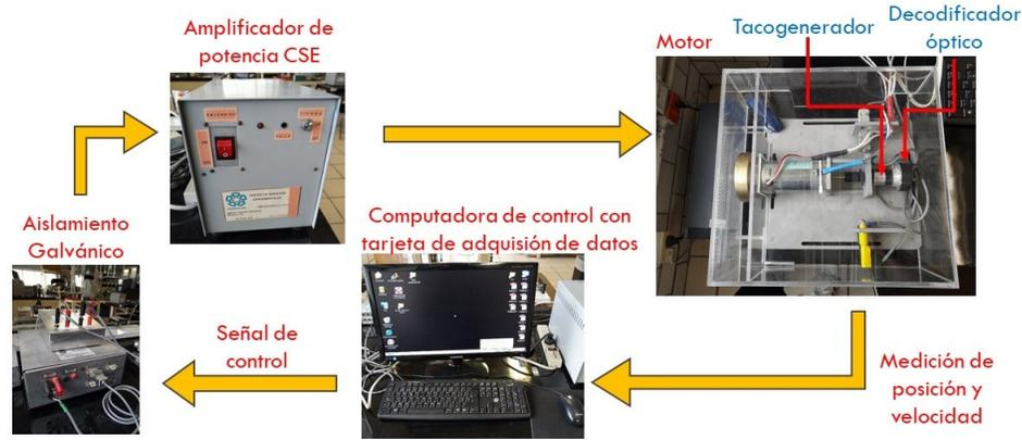
Fig. 7. Arquitectura de la plataforma experimental de alto desempeño.
