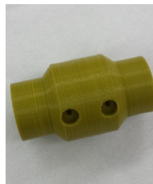
Fig. 6. Sensor de volume real com tubo de Venturi para medição de fluxo (vista panorâmica).
