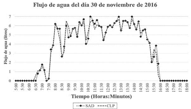
Fig. 23. Comparación del flujo de agua bombeado entre SAD y CLP (30/11/2016).
