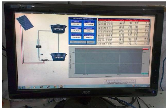
Fig. 18. Pantalla principal del sistema de supervisión comercial.
