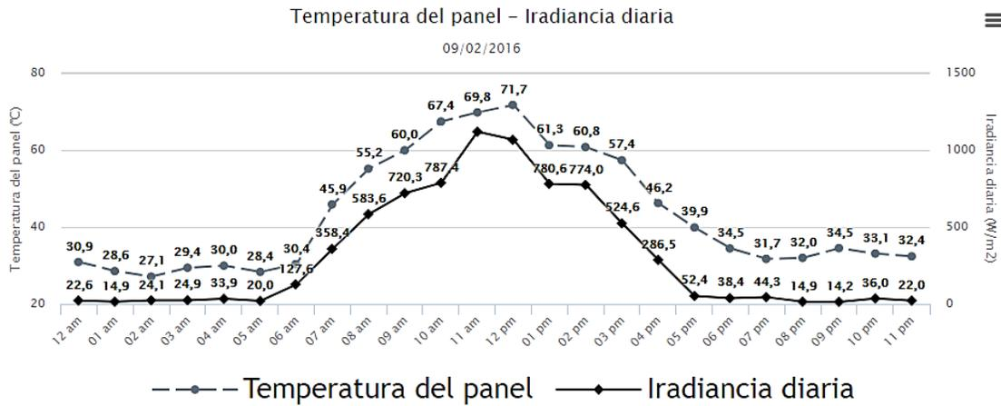
Fig. 13. Temperatura del panel y irradiación solar en período lluvioso (09/02/2016).
