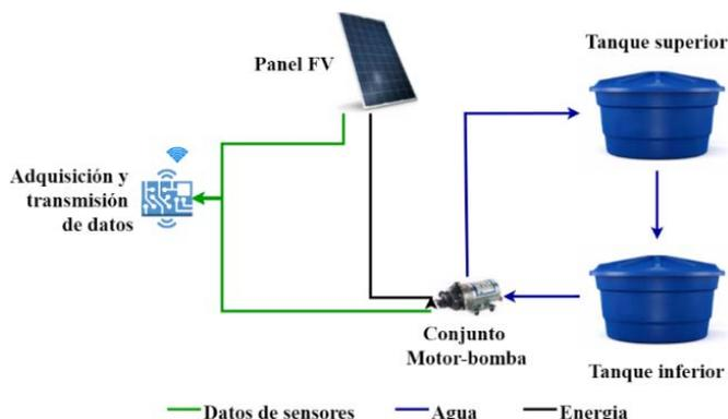
Fig. 2. Diagrama de la planta de bombeo fotovoltaico.
