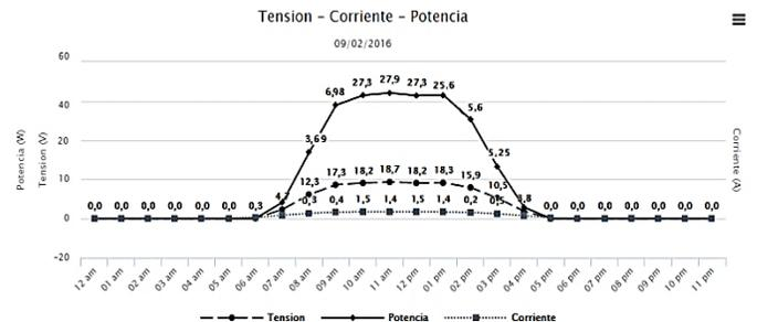
Fig. 15. Tensión, corriente y potencia del panel FV en período lluvioso (09/02/2016).
