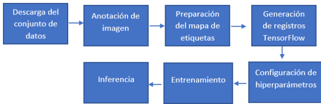
Fig. 6. Fases de implementación del API de detección de objetos de TensorFlow [31].
