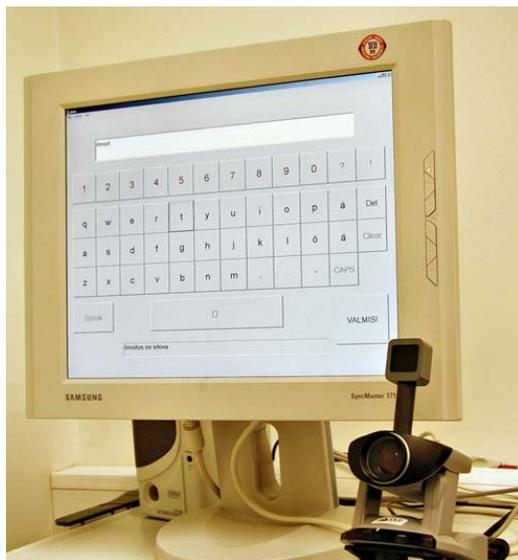
Fig. 1. Exemplo de teclado virtual e dispositivo de rastreamento ocular.
