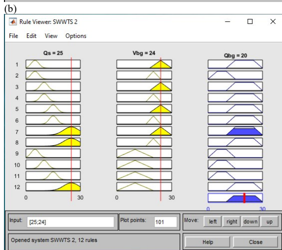
(c) Fig. 6. Simulação para 25 % da vazão total do esgoto: 10 Nm 3 , 20 Nm 3 e 24 Nm 3 de biogás no gasômetro.
