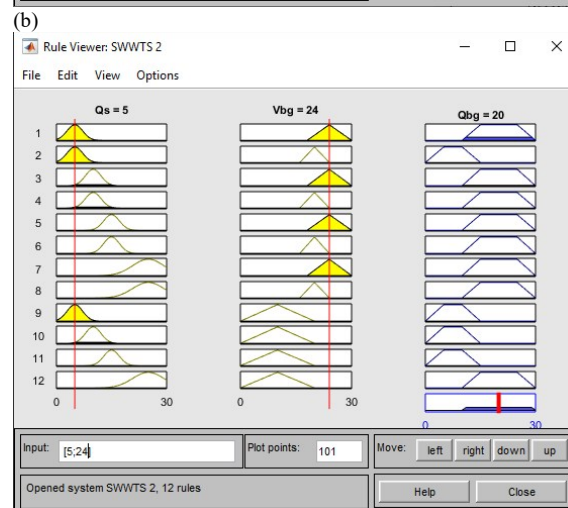
(c) Fig. 3. Simulação para 5 % da vazão total do esgoto: 10 Nm 3 , 20 Nm 3 e 24 Nm 3 de biogás no gasômetro.
