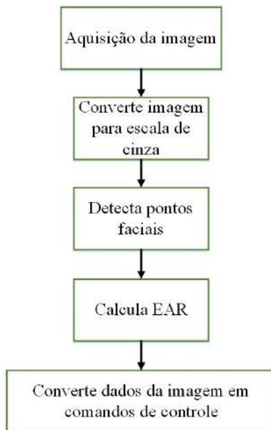
Fig. 6. Fluxograma com as etapas de processamento e controle da cadeira de rodas por meio de visão computacional.
