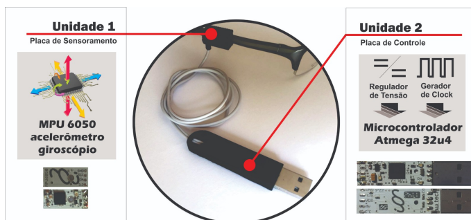
Fig. 3. Infográfico do dispositivo IOM com a indicação dos componentes das duas placas desenvolvidas.
