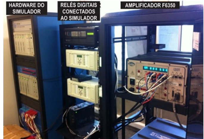
Fig. 6. Estrutura Hardware-in-the-loop utilizado neste trabalho.
