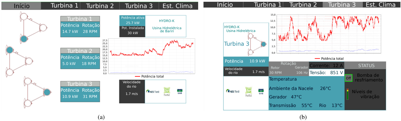
Fig. 8. Interface gráfica projetada para monitoramento da turbina HK-10, desenvolvida no software ScadaBR. (a) Representação inicial do sistema geral para o ensaio realizado na hidrelétrica UHE Bariri (b) Aba individual da turbina 3.
