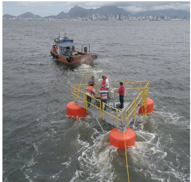
Fig. 9. Ensaio em reboque da plataforma de turbinas hidrocínética.
