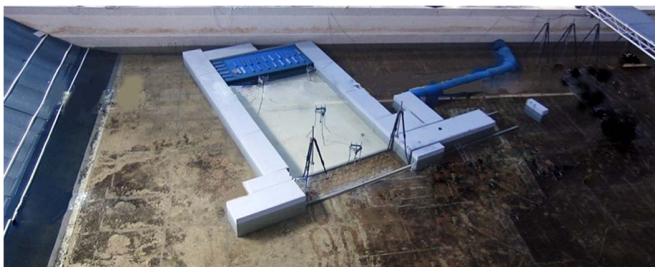
Fig. 5. Modelo a escala 1:22 del dique seco de la zona de Campamento, en la Bahía de Algeciras, realizado en el laboratorio HRL-UPM.
