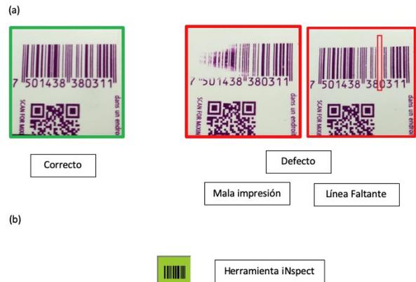
Fig. 8. Ejemplos de fallas para el primer caso de estudio, a) Códigos de barra impresos y b) Herramienta utilizada.
