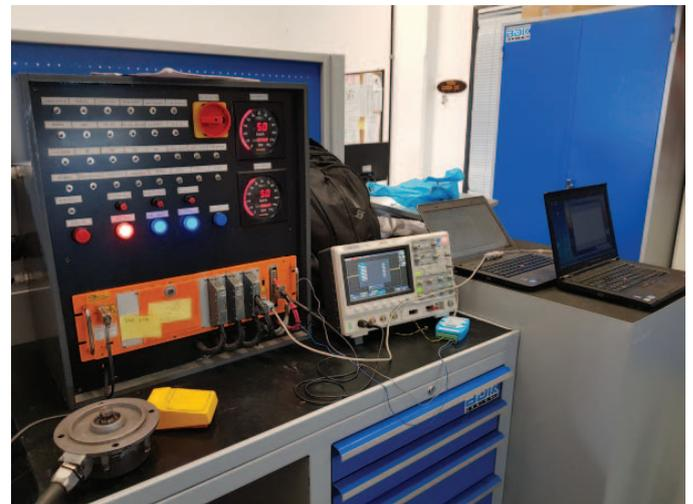
Fig. 5. Banco de pruebas utilizado para el relevamiento de las tramas emitidas por el equipo Hasler Teloc 1500.
