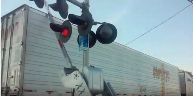
Fig. 1. En la imagen se observa un brazo de barrera que es probable que resulte destruido al bajar sobre un camión.
