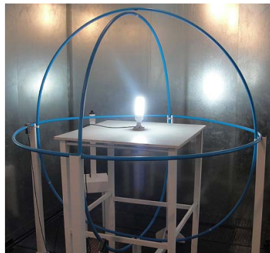
Fig. 3. Esquema de medição das perturbações eletromagnéticas radiadas na faixa de 9 kHz a 30 MHz utilizando uma Antena Loop.
