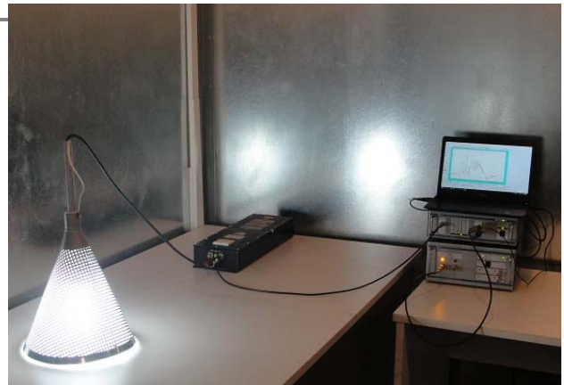
Fig. 2. Esquema de medição das tensões de perturbação nos terminais de alimentação utilizando a LISN.
