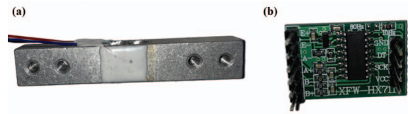
Fig. 7. Detecção da variação da massa de filamento: (a) célula de carga; (b) módulo hx711 .
