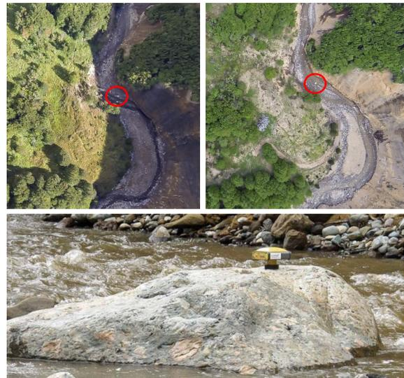
Fig. 4. GCP Natural (inferior); imágenes aéreas 2014 (superior izq.) y 2015 (superior der.) destacando el GCP.
