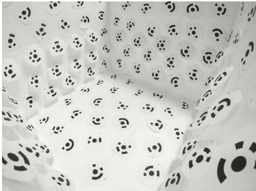
Fig. 3. Habitación cúbica para calibración del lente Ojo de Pez [18].
