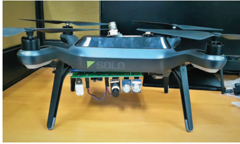
Fig. 6. Sistema de monitoreo montado en el dron. Los sensores se encuentran en la parte baja del dron.
